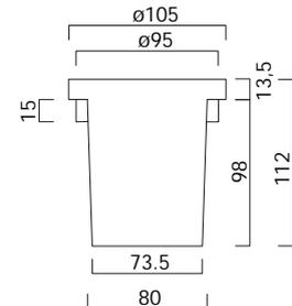
**Boden - Einbauleuchte mit Einbautopf**
